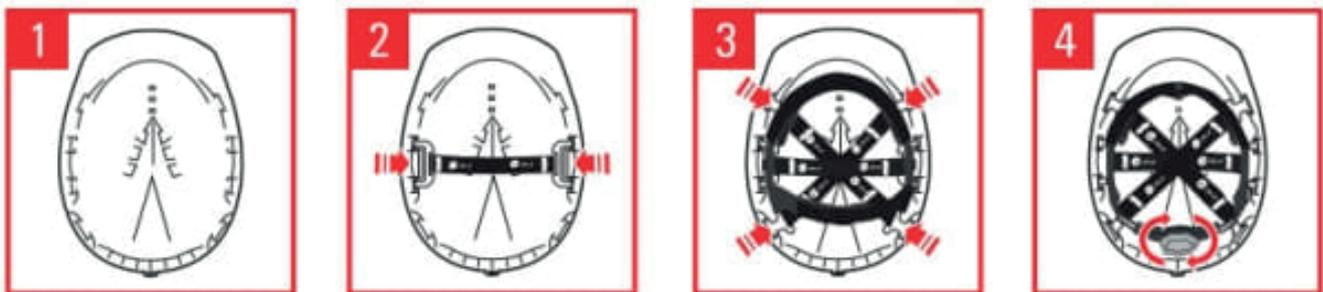
1. Inspeccione visualmente su caso antes de iniciar la instalación con el fin de verificar la existencia de cualquier señal de desgaste (rajaduras fisuras etc). Posicione el casco con la parte interna hacia arriba con la visera apuntando hacia afuera.
